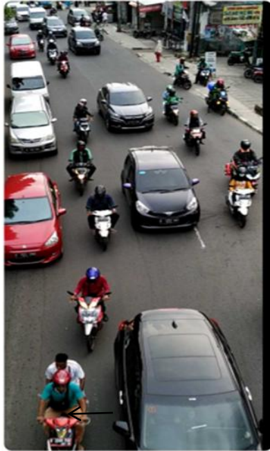
Rajah 3.3 Menangkap video kendaraan dengan sudut 45^{\circ} dari ketinggian kamera 3 meter yang disorot ke arah kendaraan di bawah
